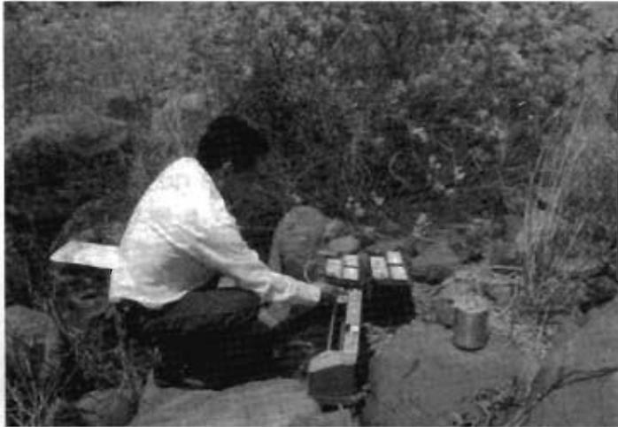
Foto 3. En ésta imagen, se muestra un sismógrafo con su sensor (cilindro de la derecha), para detectar los movimientos sísmicos generados en la parte interna del volcán Popocatepetl
