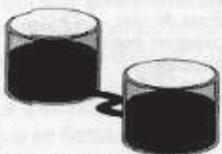
Cuanto más largo es el conducto, más se disminuye el caudal de agua.
