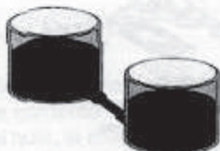
Cualquier reductor en un conducto frena el caudal de agua.
