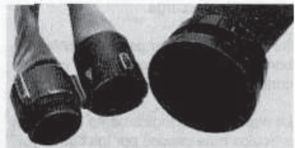
Empalmes con rosca (izquierda) y de acción rápida (derecha)
